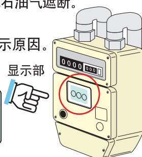
\*如果液化石油气警报器与燃气表联动，在警报鸣响时，也会进行与地震遮断同样的显示。
